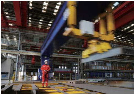
< 海油工程天津智能制造基地的结构预制车间，工程师坚守一线，正在对智能吊运组对门架进行调试。智能吊运组对门架可通过自动扫描二维码识别型钢信息，并根据图纸对型钢自动吊运组对
